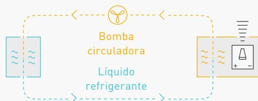
Generador pulsado monobloque: el calor se transfiere a un radiador calórico incorporado
