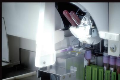
Cada tubo es sujetado uno por uno por el brazo robótico y es mezclado suavemente por inversión completa. El sistema de carga automática contribuye con la rapidez del reporte, favorece la toma de decisiones y hace más eficiente el flujo de trabajo del laboratorio.
